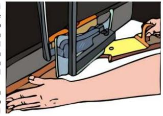
lavoro, preferibilmente non alla guida, ampie e robuste (la battuta di ingresso è di importanza fondamentale per contenere l'eventuale "rifiuto del pezzo"). Va utilizzato anche l'elemento pressore verticale del dispositivo di protezione integrato.
